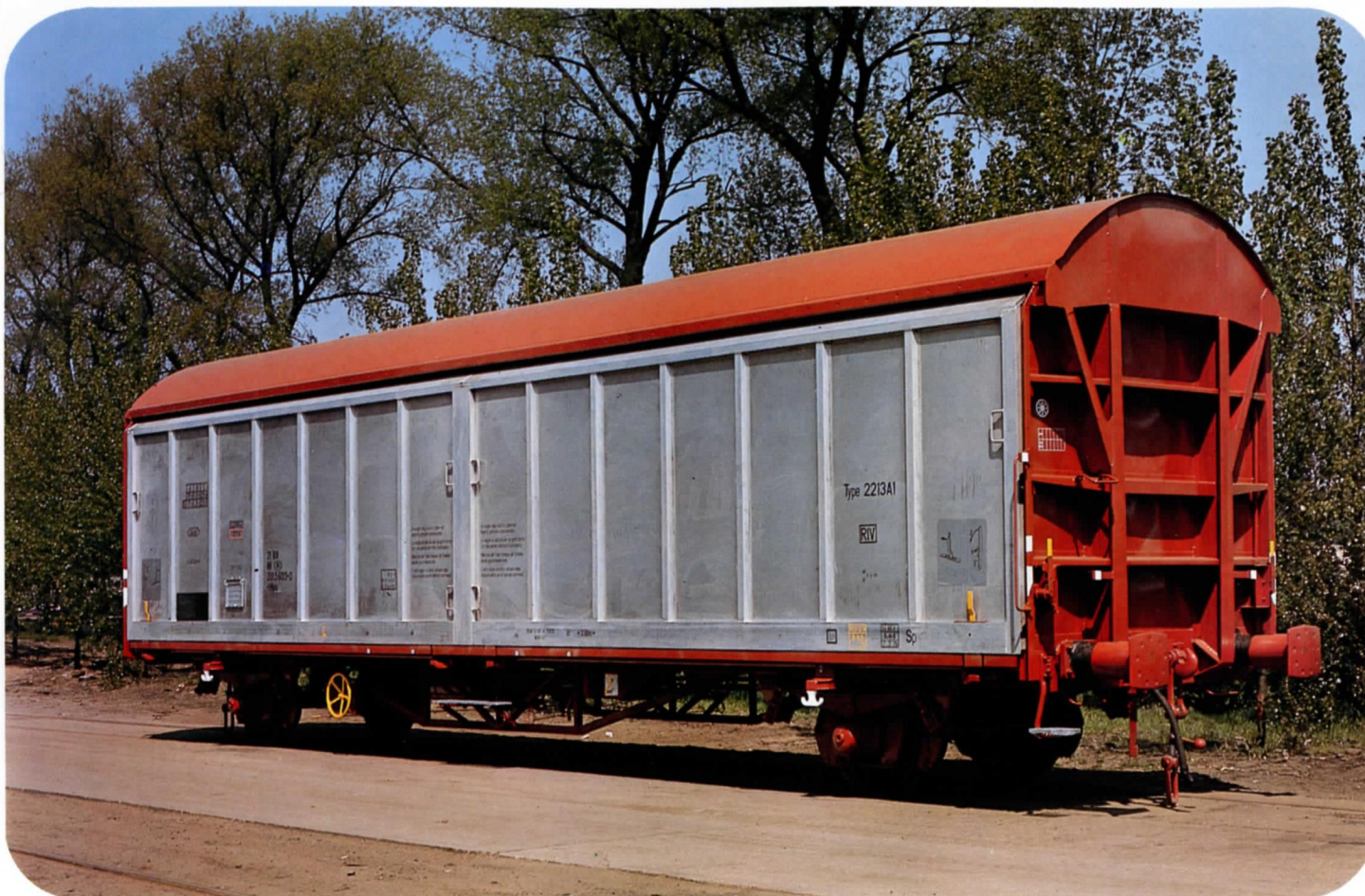
Covered wagon with sliding side walls Wagon fermé à parois coulissantes Gesloten wagen met schuifwanden
