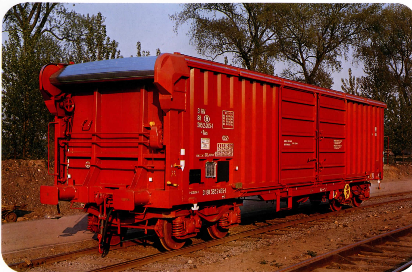
Wagon equipped with a rolling roof Wagon tombereau à toit enrollable Stortwagen met oprolbaar dak
