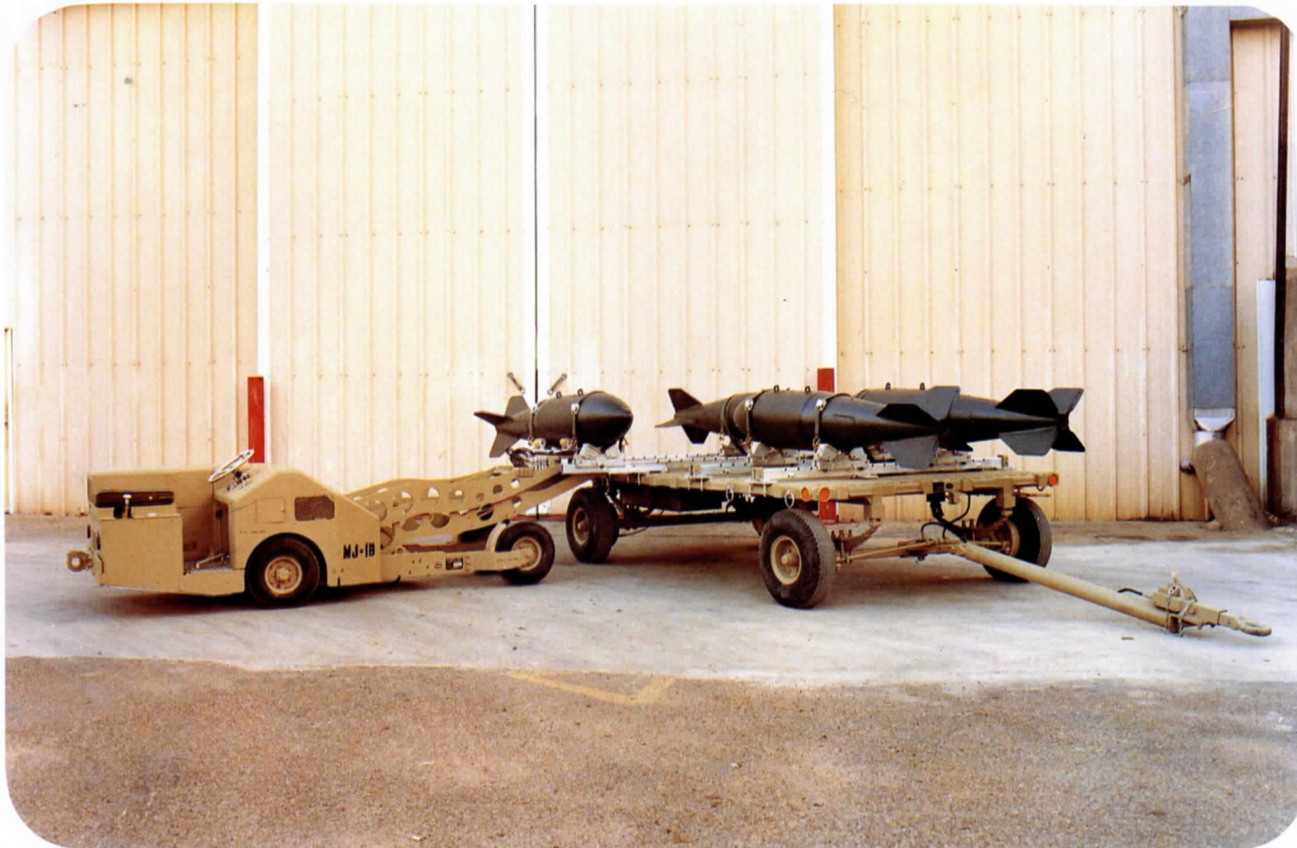
MJ 1 "B" weapon loader and transport trailer MJ 1 "B" chariot élévateur et remorque MJ 1 "B" bomhefruck en transportwagen
